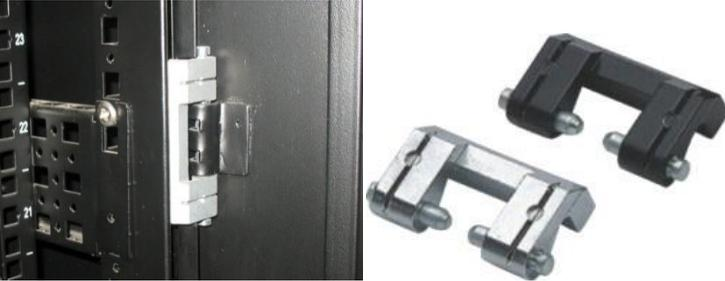
每套锌合金铰链带有两个插销，分别从两端插入柜门的旋转卡槽内。拆卸柜门时分别将铰链上的两个插销向上、下两个方向拉出，使柜门与机柜框架分离。见下图所示：
